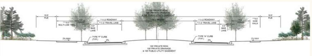
100' RIGHT-OF-WAY SECTION PICAL COLLECTOR w/ BIKE LAN
